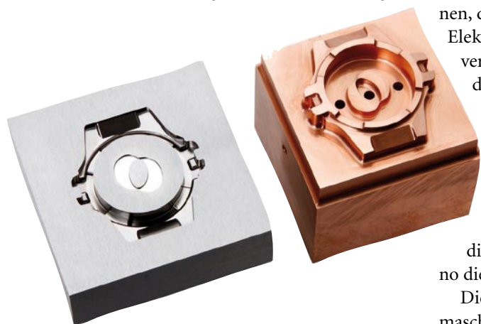
Typische Aufgabe für die EDAF-Serie: Form für Uhrengehäuse.
