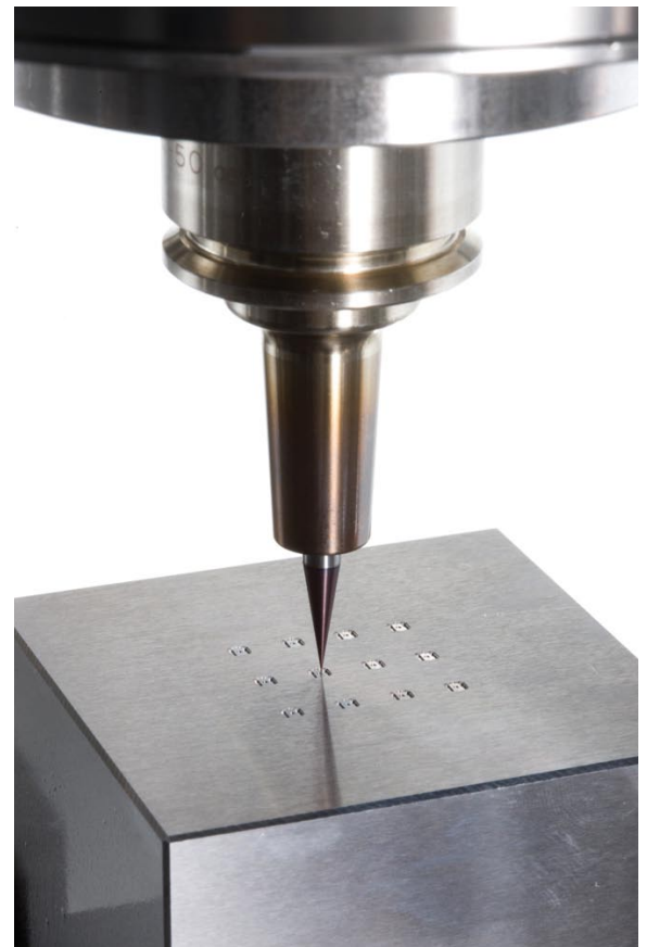
Das vertikale Präzisions-Mikrobearbeitungszentrum iQ300 im Einsatz: Bearbeitung eines Mikroprozessor-Gehäuses (Abmessungen: 2,5 mm x 2,5 mm).
