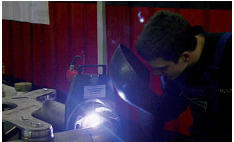
Kompakt und besonders für Rohr-Rohr-Verbindungen mittlerer Wanddicken geeignet: offene Orbitalschweisszangen des Typs MU für Edelstahlrohre unterschiedlicher Durchmesser. (Bild: Polysoude)
