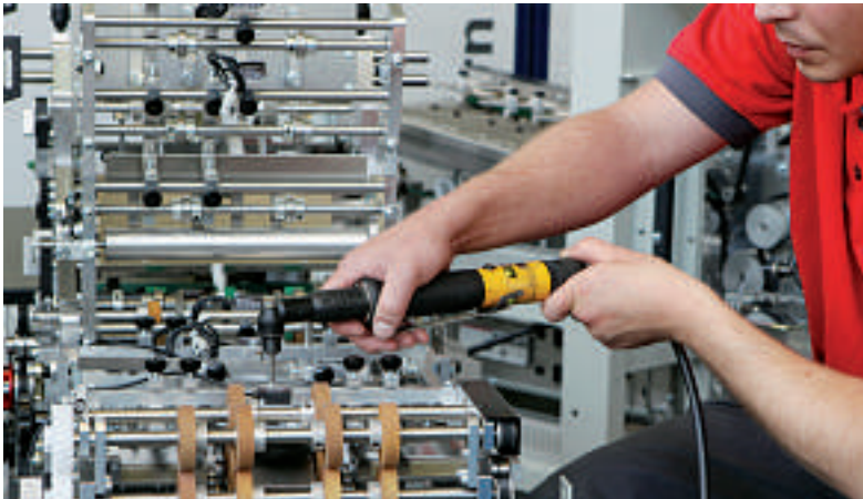
Tensor-DL-Schrauber montieren bei Kern in zwei Werken jährlich rund 1,5 Mio. Schrauben prozesssicher. Durch den kleinen Winkelkopf sind schwer zugängliche Schraubstellen leicht zu erreichen. (Bilder: Atlas Copco Tools)
