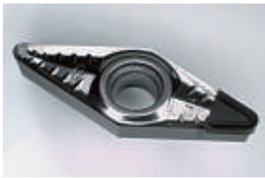
Auf der Laser Line bearbeitete PKD-Wendeschneidplatte: Schneide und Spanleitstufe wurden komplett in einer Aufspannung gefertigt.
