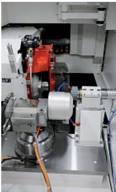
Die Wendeschneidplatten-Umfangschleifmaschine Insert Line bietet variable Schleifscheibendurchmesser, sodass auch konkave Formen geschliffen werden können.
