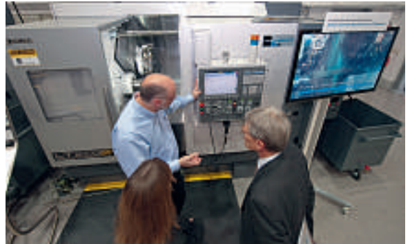
Okuma-Mitarbeiter Jürgen Kläser (M.) informiert über das neue Drehzentrum LT 2000 EX mit drei Revolvern, das für die wirtschaftliche und präzise Komplettbearbeitung universeller Drehteile in mittleren bis grossen Losen gedacht ist.
